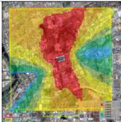
图 6-45 PM 2.5 叠加背景值年均浓度等值线分布图(项目第一阶段)(µg/m 3 )
