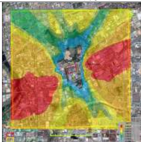
图 6-15 PM 2.5 最大日均贡献浓度等值线分布 图(项目第一阶段)( \mu\text{g}/\text{m}^3 )
