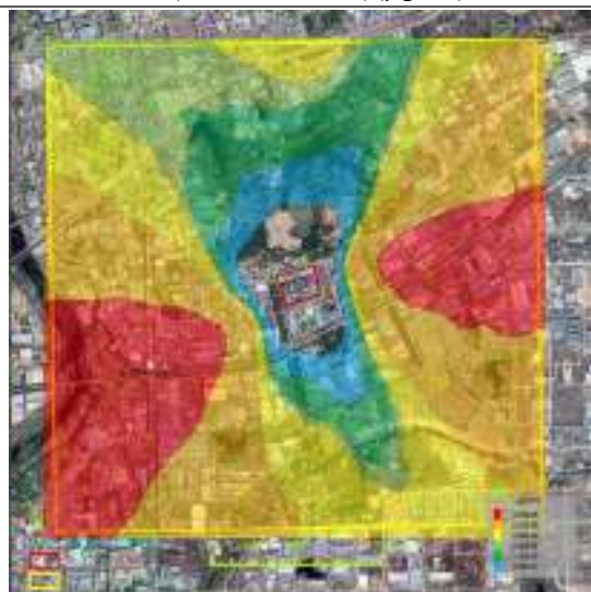
图 6-27 Hg 最大年均贡献浓度等值线分布图 (项目第一阶段)( \mu\text{g}/\text{m}^3 )
