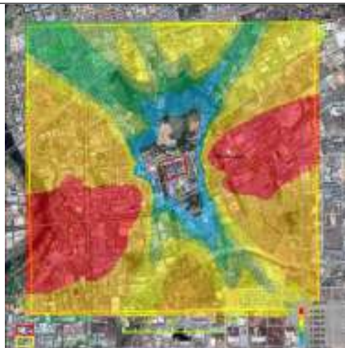
图 6-13 NO 2 最大日均贡献浓度等值线分布图 (项目第一阶段)( \mu\text{g}/\text{m}^3 )
