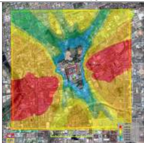
图 6-14 PM 10 最大日均贡献浓度等值线分布 图(项目第一阶段)( \mu\text{g}/\text{m}^3 )
