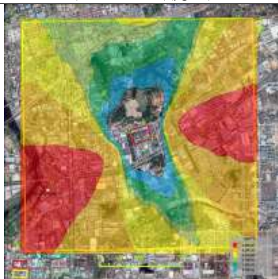
图 6-29 SO 2 最大年均贡献浓度等值线分布图 (项目整体)( \mu\text{g}/\text{m}^3 )
