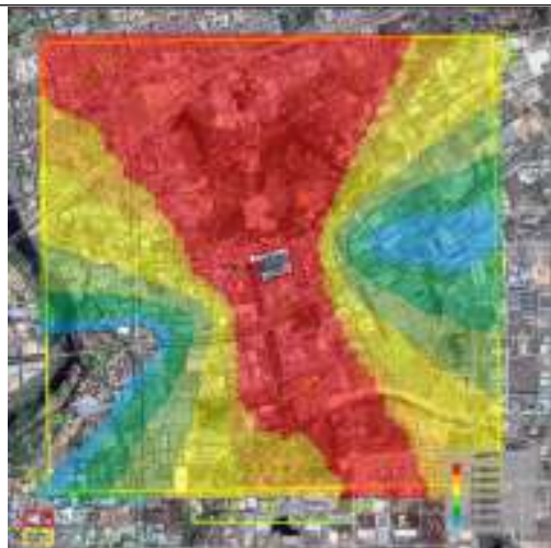
图 6-44 PM 10 叠加背景值年均浓度等值线分布图(项目第一阶段)(µg/m 3 )
